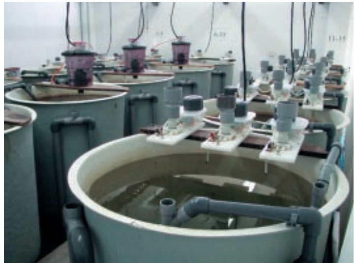
Detalle de los tres comederos de auto-selección de macronutrientes por el sargo picudo.
