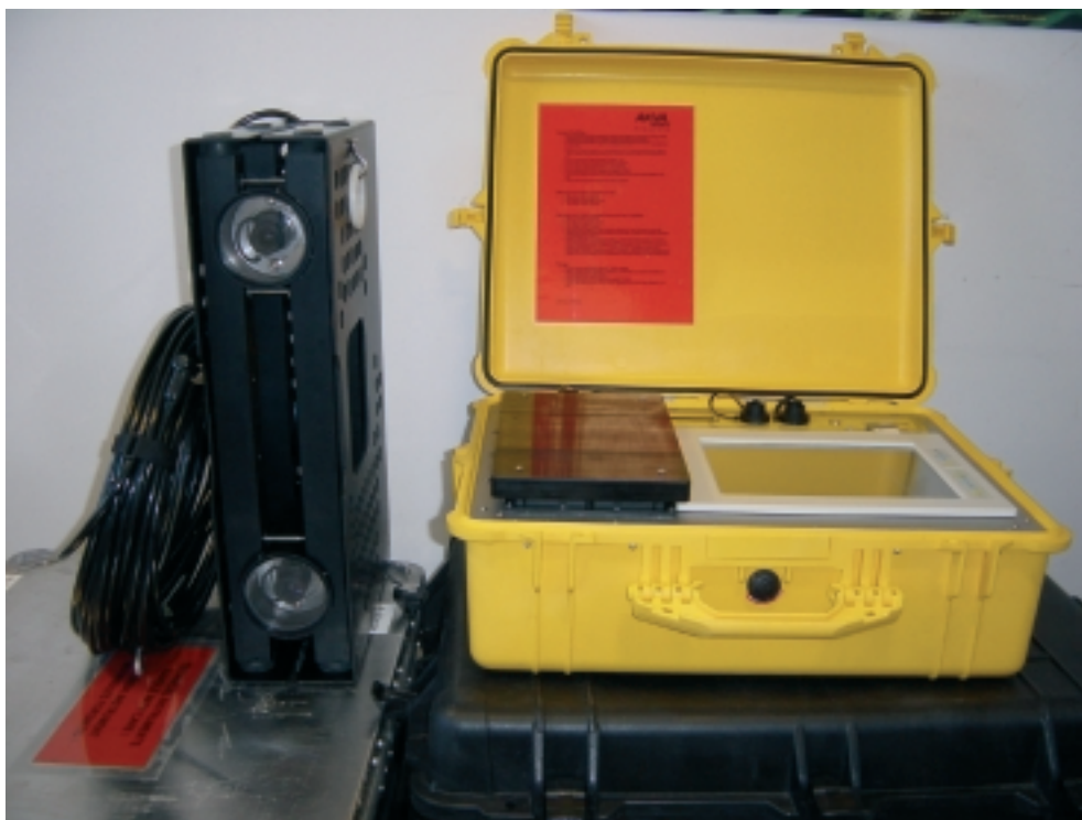
Equipo de visión estereográfica sumergible, y de estimación de biomasa para peces marinos (VICASS, Akva Smart)
