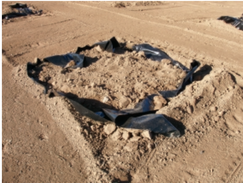
Foto 2 Lisímetro de 1,5 m x 1,5 m. Impermeabilizado para ubicación de un árbol.
