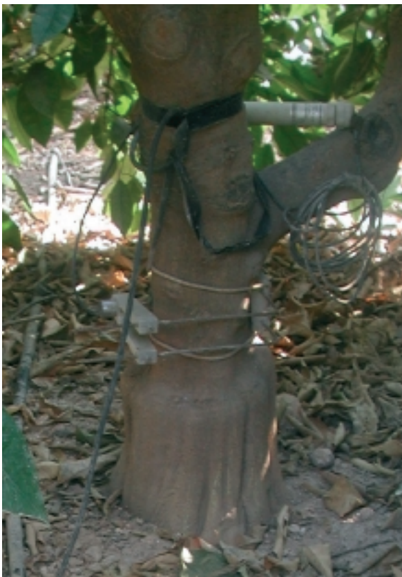
Figura 1 Control del estado hídrico del cultivo mediante dendrómetros de tronco del tipo LVDT.
