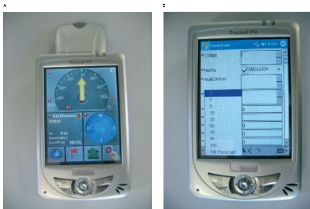
Figura 1 PocketPC mostrando: a) el navegador GPS y la antena desplegada; b) base de datos configurada para la recogida en campo
